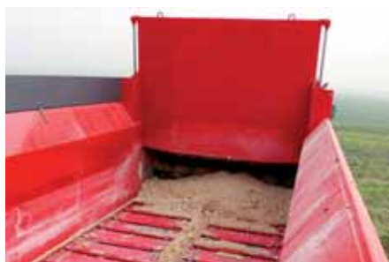
– Zmiana ustawienia zasowy skrzyni ładunkowej powinna służyć tylko do wyrównywania strumienia podawanego materiału, a nie jego dozowania – podpowiada Piotr Stanek.
