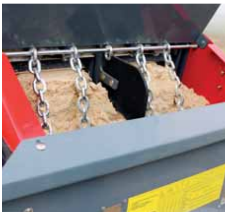
Łańcuchy w RCW 120TD mają za zadanie rozbić zbitą materię, zanim trafi na tarcze rozsiewające.
