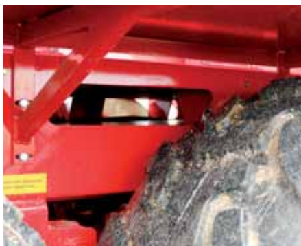
Otwory technologiczne w ramie RCW 120TD umożliwiają mycie myjką miejsc trudno dostępnych.
