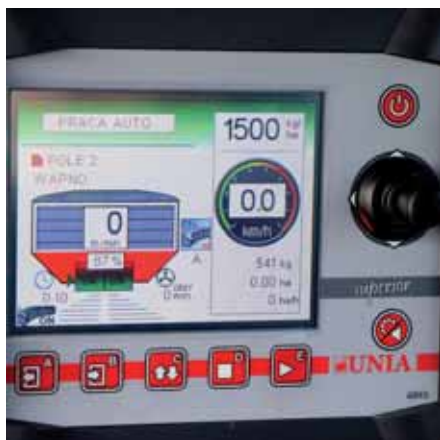
Rozsiewacz RCW 120TD obsługuje się poprzez sterownik Superior montowany w kabinie ciągnika.
