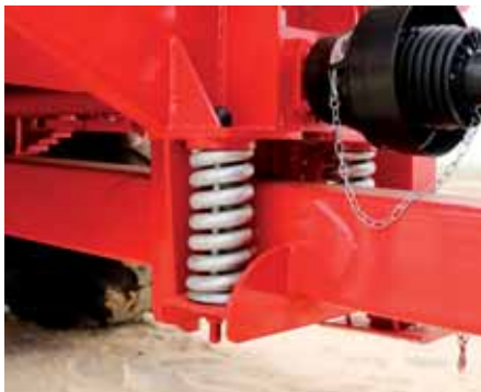
Zaczep RCW 120TD jest resorowany przez dwie solidne sprężyny.
