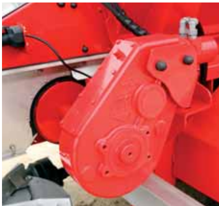
W RCW 120TD silnik hydrauliczny za pośrednictwem przekładni redukcyjnej generuje do 5000 Nm momentu obrotowego. W ten sposób napędzana jest taśma podłogowa.
