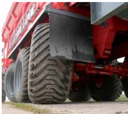
Tytan 36 ma resorowany 3-osiowy układ jezdny, w którym pierwsza i trzecia oś są samonastawne.
