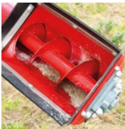
Przełożnik ślimakowy belki wysiewającej ma średnicę 150 mm.
