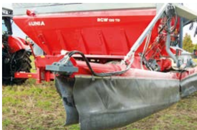
Belka wysiewająca ma możliwość uniesienia do pozycji „V” w celu bezpiecznego wykonania uwroci na nierównych polach.
